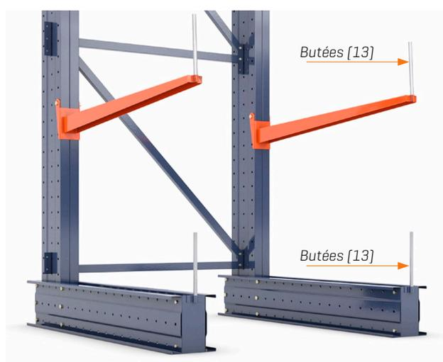
Il est fréquent que dans le rayonnage cantilever soient stockées des marchandises qui, du fait de leurs caractéristiques physiques et parce qu'elles ne sont pas emballées ou dûment fixées, peuvent se déplacer vers l'avant des bras et tomber. Pour éviter cela, des butées de retenue verticales [13] peuvent être installées aux extrémités des bras et des bases.
