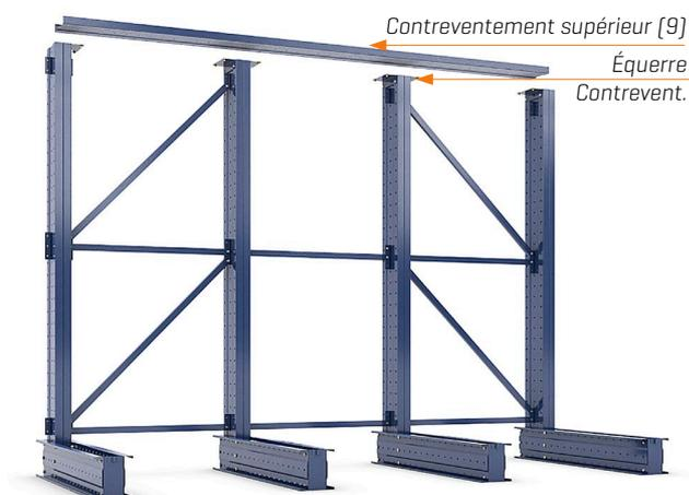
Les colonnes d'une hauteur supérieure ou égale à 3 000 mm doivent s'unir au moyen d'un élément de contreventement supérieur [9] disposé à l'horizontale sur ses extrémités.
