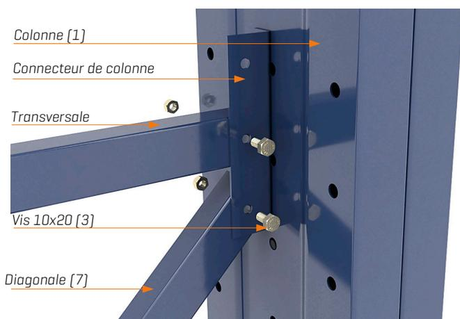
Les diagonales [7] et les transversales [8] se fixent à l'aide de vis M10x20 [3] aux connecteurs situés sur les côtés des colonnes.
