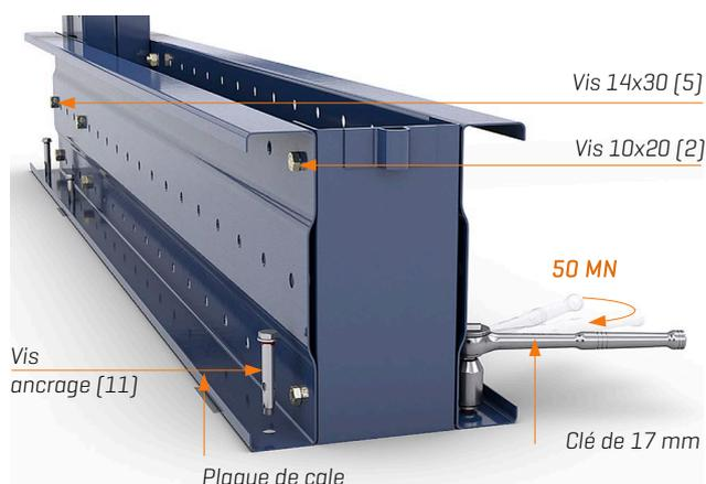
Les bases doivent être nivelées en utilisant, le cas échéant, des plaques métalliques de cale. Ensuite, terminer de serrer les vis 10x20 [2] de la base avant, comme indiqué dans l'étape 2.
