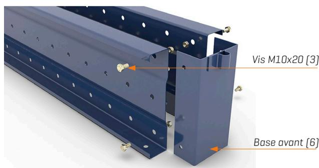
Une base avant [6] est fixée à l'intérieur de l'extrémité antérieure des bases, en guise de fermeture des bords des deux bases, en la fixant à l'aide de quatre vis M10x20 [3].
