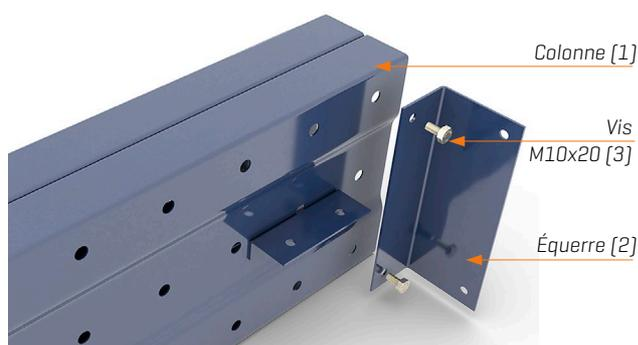
L'union se fait en fixant le côté le plus étroit de l'équerre à la colonne, à l'aide de deux vis M10x20 [3]. Le bord de la colonne et la face la plus large de l'équerre sont alignés.
