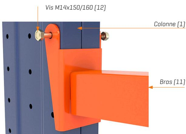
La fixation du bras [11] à la colonne se réalise à l'aide d'une vis M14x150 ou M14x160 [12], en fonction de sa largeur.
