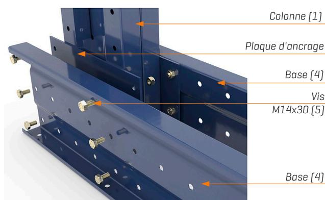
Fixer l'extrémité des bases aux plaques d'ancrage situées sur les côtés inférieurs de chaque colonne, à l'aide de six vis M14x30 [5].
