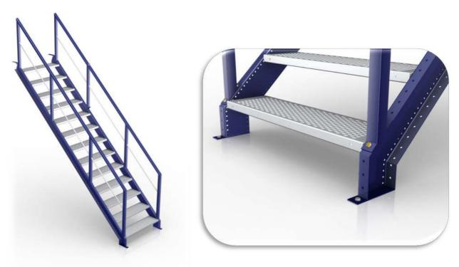
L'escalier démontable est composé de deux limons, fabriqués avec des profilés en « U », en acier laminé à froid, où se vissent les échelons et la rambarde. Sur les montants de rambarde est introduite la protection de 20 mm de diamètre, où la main courante s'appuie, dans sa partie supérieure. Ce système dispose des éléments de finition adéquats.
