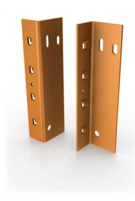
La fixation à l'échelle se réalise au moyen de quatre saillies de 11 mm, effectuées dans le connecteur, qui s'encastrent dans les trous correspondants de l'échelle. Ce type d'union est spécifiquement conçu pour transmettre correctement les poussées de la charge de service en minimisant les efforts du système, autocentrant les compressions afin d'éviter les risques de tensions de cisaillement.
