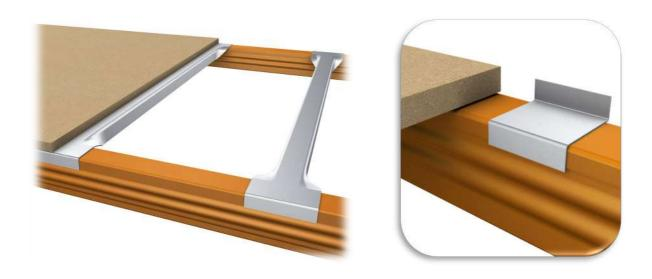
Détail niveau picking classique avec support et butée de retenue
