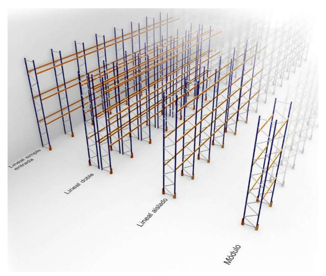
Les alignements de corps délimitent des couloirs dont la largeur est déterminée par les normes applicables, les moyens de manutention disponibles, les dimensions des unités de charge et par le mode d'accès à cellesci.
