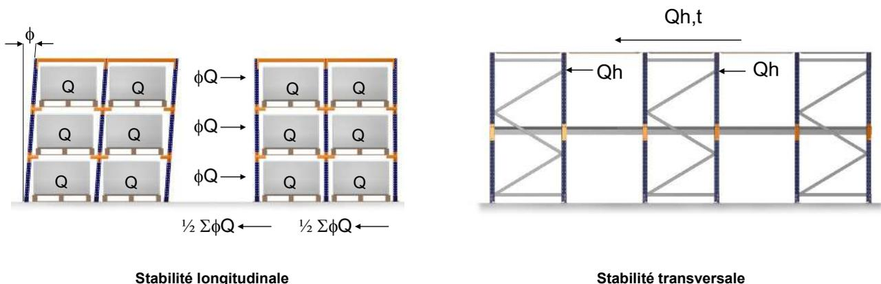
La définition des hypothèses de charge a été réalisée en prenant en compte les directives de la norme EN 15512 selon les conditions de calcul précédemment exposées, vérifiant les tensions, les déformations et la stabilité longitudinale et transversale, envisageant les actions constantes et variables qui influent sur la structure.
