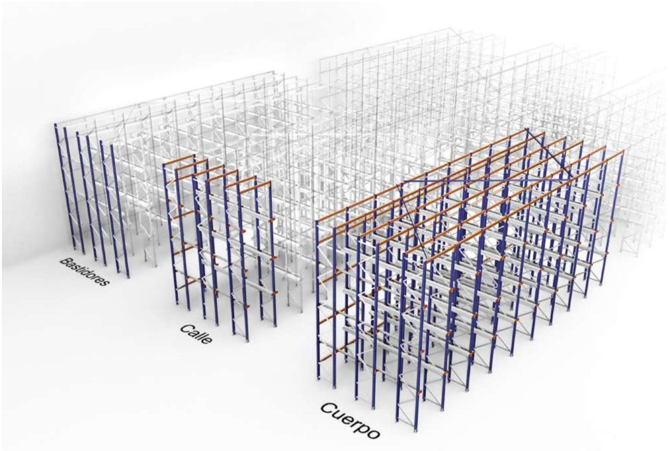
Le système structural composé par plusieurs rues et plusieurs niveaux de charge s'appelle corps. Les corps peuvent être à entrée simple si la structure est proche du mur, ou à entrée double s'ils sont praticables des deux côtés en même temps. Les corps à double accès multiplient par deux le rendement du système en accélérant la rotation des stocks.
