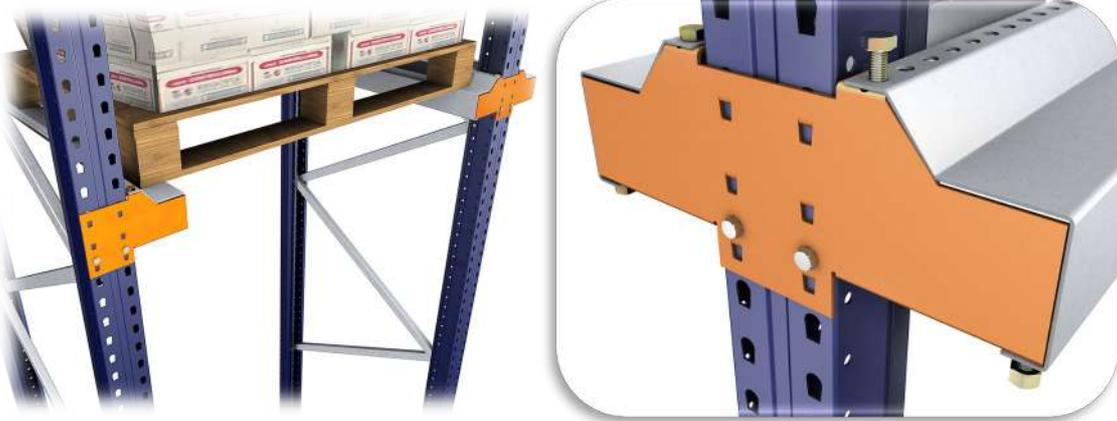
Détail fixation entre rail centreur et console avec vis 10x20
