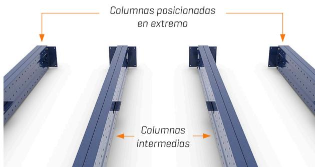
Las columnas de altura igual o mayor a 3000 mm, llevarán fijadas en su extremo superior dos escuadras de arriostramiento, una a cada lado de la misma, salvo las situadas en los extremos de la estructura, que llevarán sólo una.
