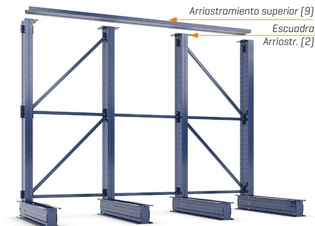
Las columnas con una altura igual o mayor de 3000 mm, deben unirse mediante un elemento de arriostramiento superior [9] dispuesto horizontalmente sobre sus extremos.
