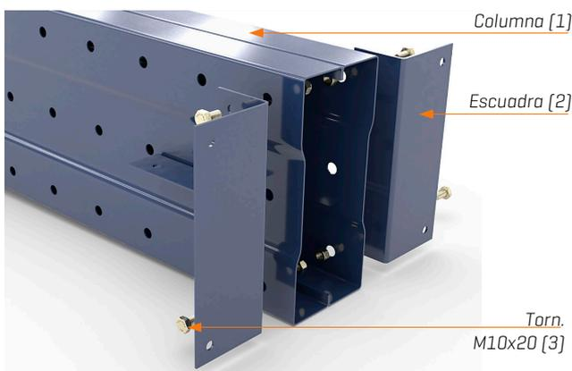
Las columnas intermedias llevarán adosadas dos escuadras de arriostramiento colocadas según se muestra en la imagen adjunta.
