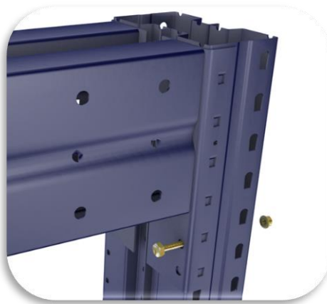
Cargaderos. Detalle de posicionamiento y fijación al pilar con tornillo 8x120
