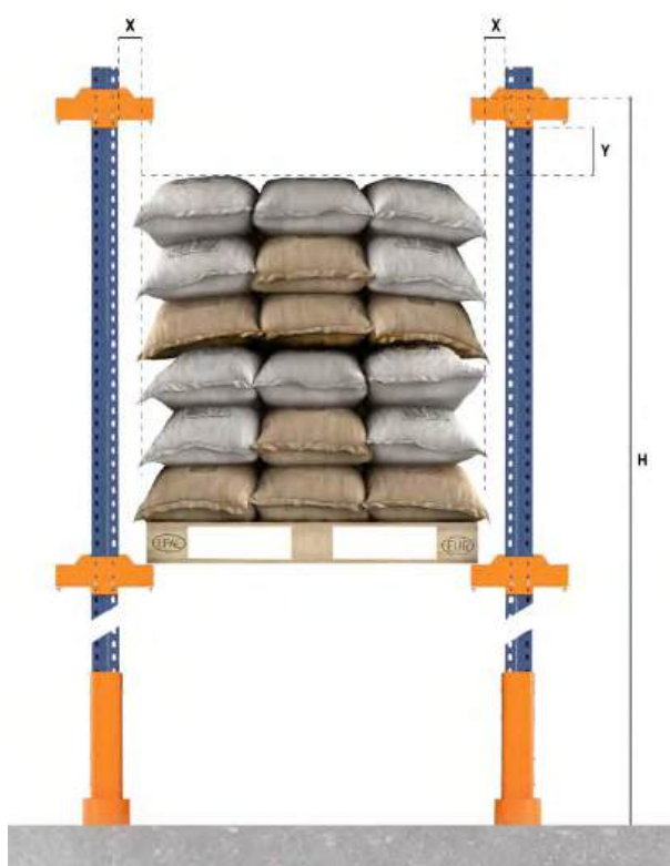
Holguras horizontales y verticales en alveolo Paletas con carga saliente situadas en niveles elevados
