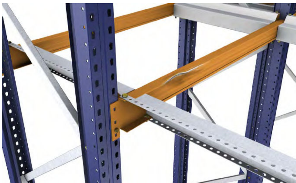
Larguero dañado por abolladura
