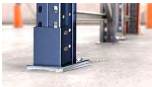
Placas de nivelación incorrectamente posicionadas
