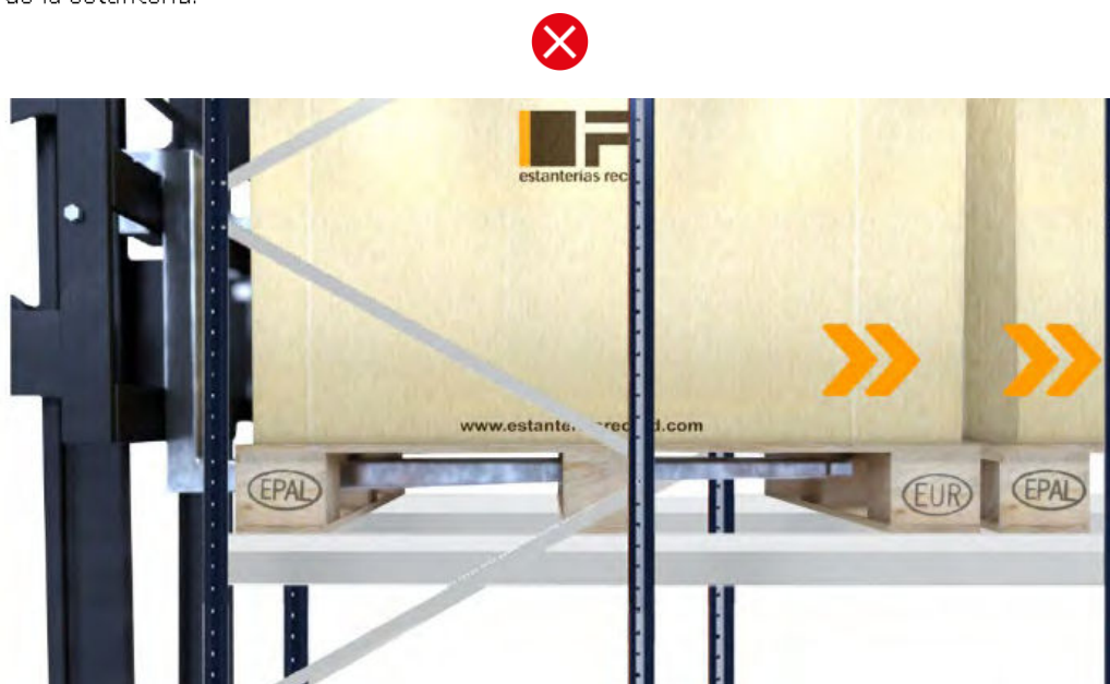
Sobrecarga sobre los carriles y las ménsulas provocado por arrastre y empuje de la paleta
