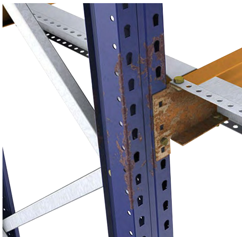
Puntera y largo dañados por deterioro de la pintura
