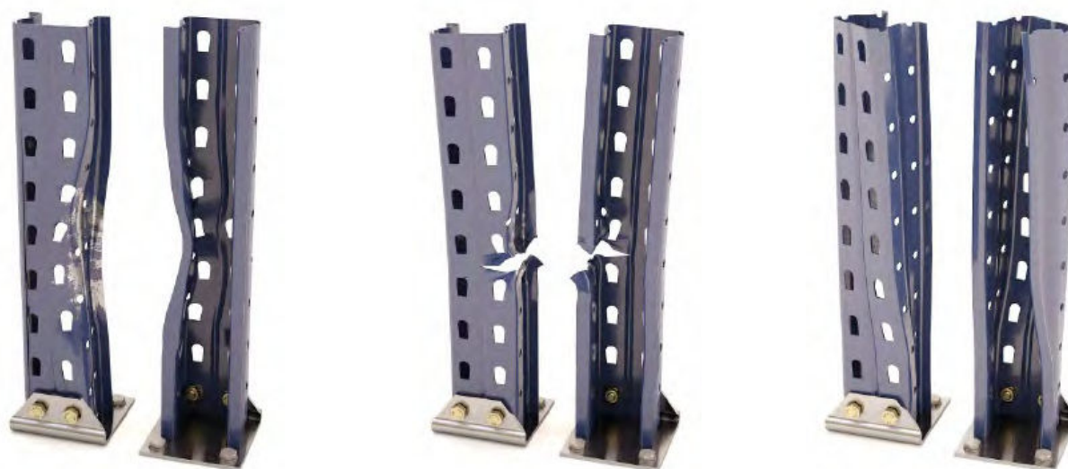
Puntales dañados por abolladura, desgarró y torsión
