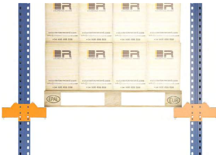
Sobrecarga por descentrado de carga
