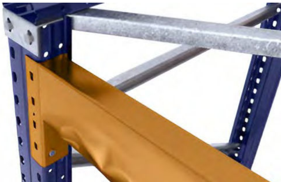
Larguero de coronación dañado por abolladura
