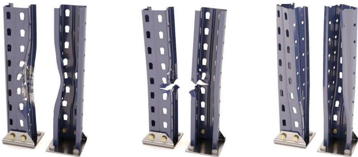
Montants cabossés, déchirés et tordus
