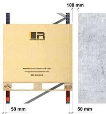
Jeux horizontaux dans la profondeur Alignements simples. Palettes sans charge saillante
