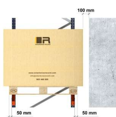
Jeux horizontaux dans la profondeur Alignements simples. Palettes avec charge saillante
