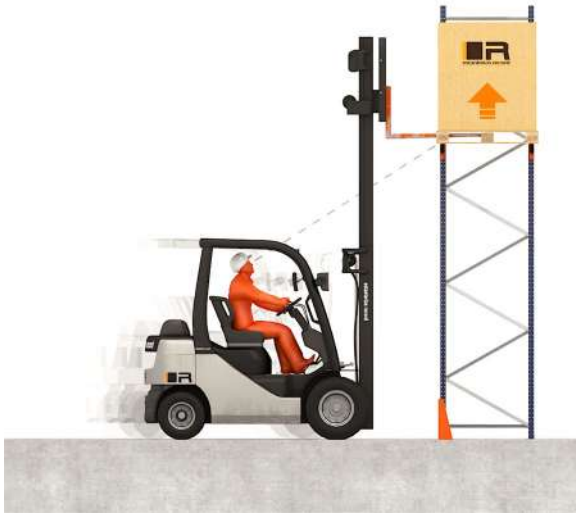
Opération de déchargement 1. Introduction des fourches sans toucher la palette
