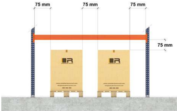
Jeux horizontaux et verticaux dans une alvéole Palettes sans charge saillante situées au sol
