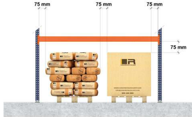
Jeux horizontaux et verticaux dans une alvéole Palettes avec charge saillante situées au sol
