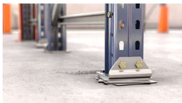
Plaques de nivellement incorrectement positionnées
