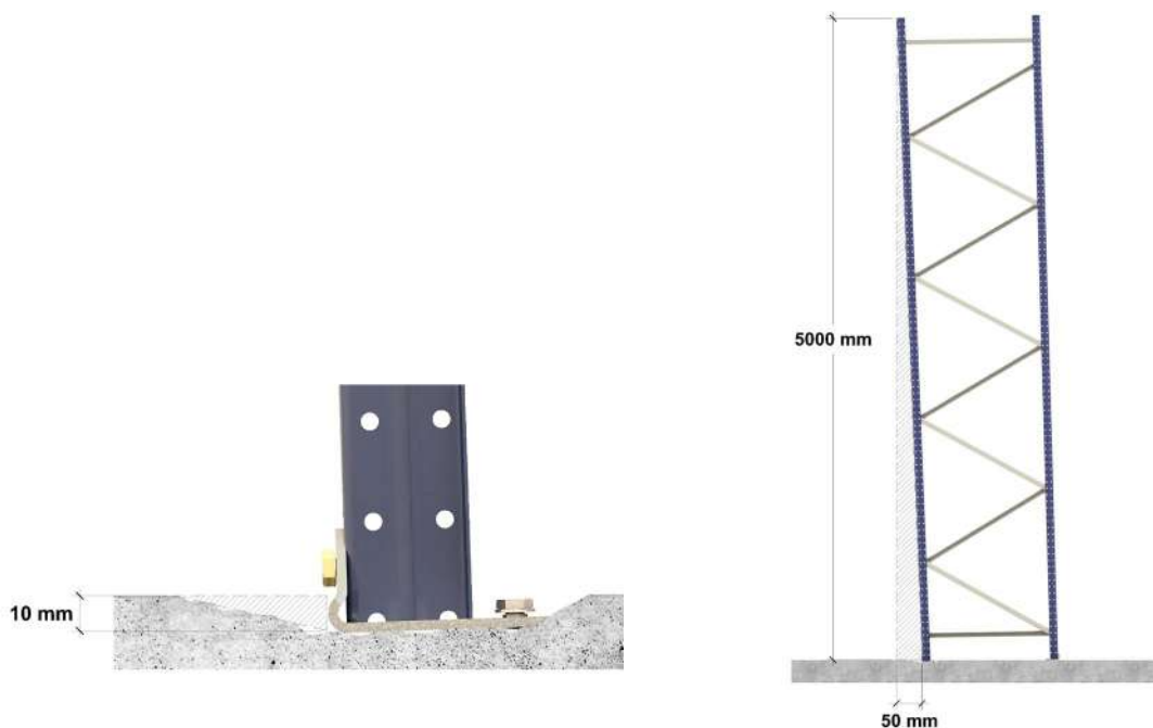
Effondrement de l'échelle dû au tassement du sol ou au poinçonnement local du montant
