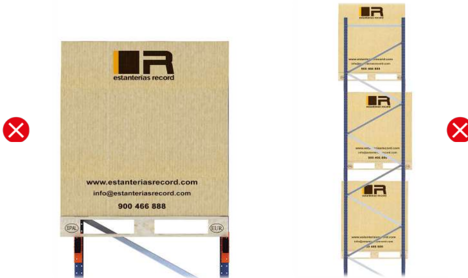
Surcharges dues au décentrage ou à l'asymétrie de la charge sur le rayonnage
