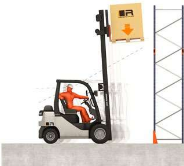
Opération de déchargement 3. Appui de la palette et enlèvement
