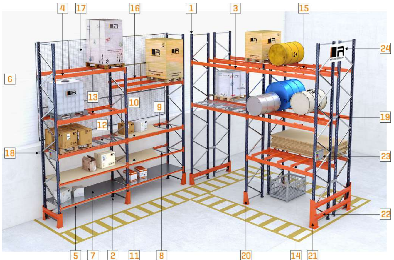
Schéma générique de rayonnage à palettes classique, composants et accessoires.
