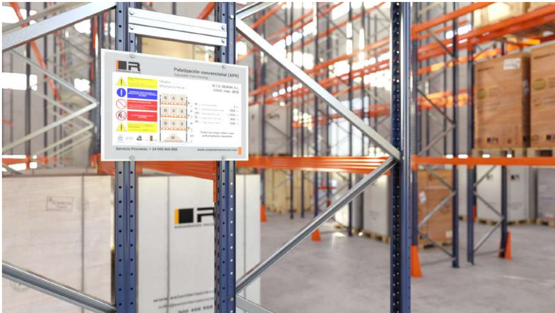
Plaque signalétique normalisée correctement située
