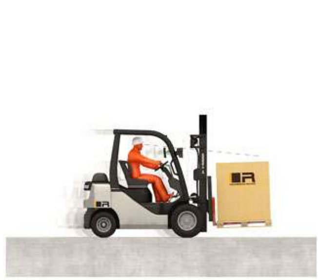
Opération de déchargement 4. Position de circulation avec charge abaissée
