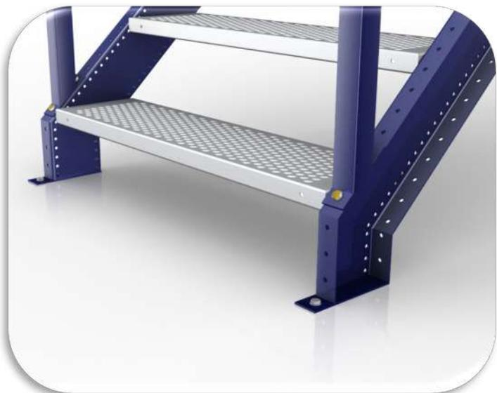
L'escalier démontable est composé de deux limons, fabriqués avec des profilés en « U », en acier laminé à froid, où se vissent les échelons et la rambarde. Sur les montants de rambarde est introduite la protection de 20 mm de diamètre, où la main courante s'appuie, dans sa partie supérieure. Ce système dispose des éléments de finition adéquats.
