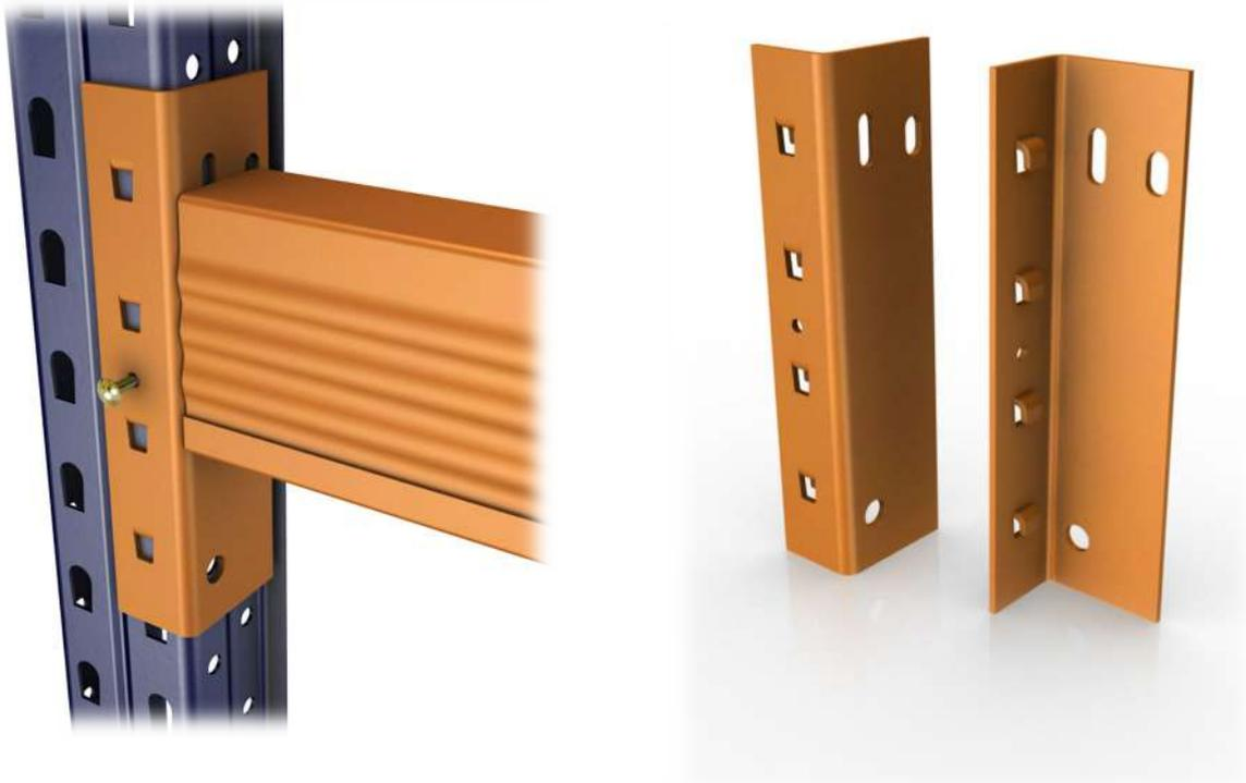
La fixation à l'échelle se réalise au moyen de quatre saillies de 11 mm, effectuées dans le connecteur, qui s'encastrent dans les trous correspondants de l'échelle. Ce type d'union est spécifiquement conçu pour transmettre correctement les poussées de la charge de service en minimisant les efforts du système, autocentrant les compressions afin d'éviter les risques de tensions de cisaillement.
