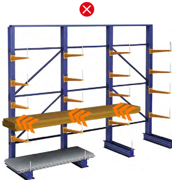
Sobrecarga producida por empuje o impacto
