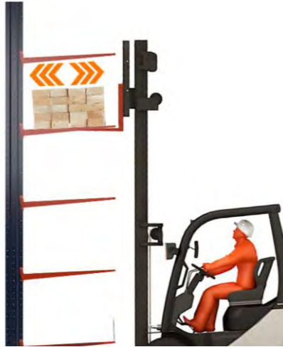
Sobrecarga sobre los brazos provocado por arrastre y empuje de la unidad de carga
