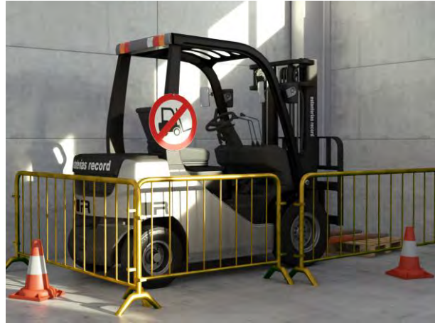
Control de daños e inmovilización para reparación
