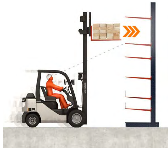
Operación de carga 2. Introducción horizontal en la posición de carga
