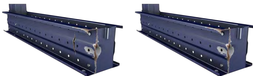
Bases dañadas por desgarro y abolladura
