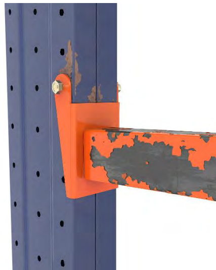
Columna y brazo dañados por deterioro de la pintura
