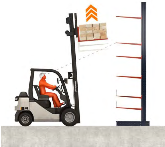
Operación de carga 1. Aproximación y posicionamiento perpendicular
