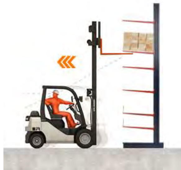
Operación de carga 4. Salida sin contacto de las horquillas
