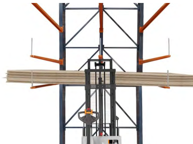
Sobrecargas en un brazo por descenso no horizontal
