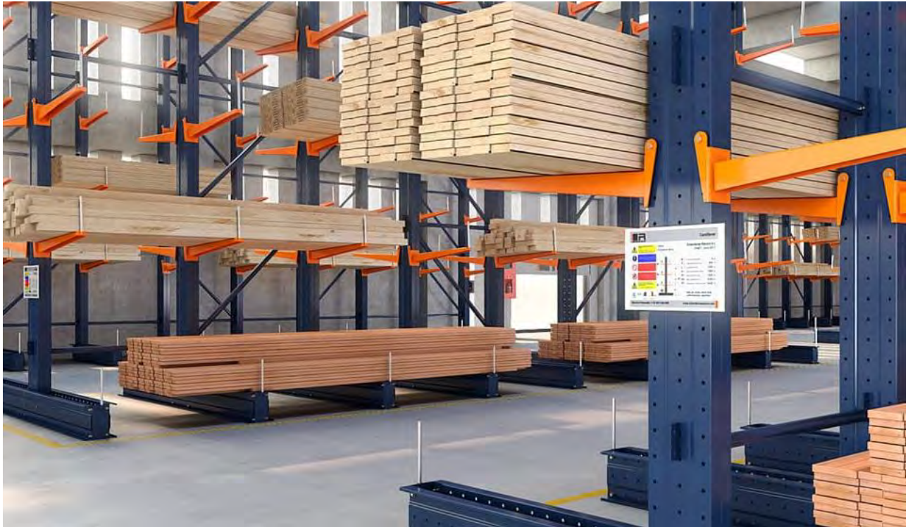
Placa normalizada de características correctamente situada
