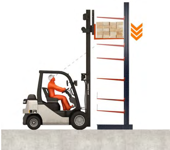
Operación de carga 3. Descanso horizontal, centrado y suave
