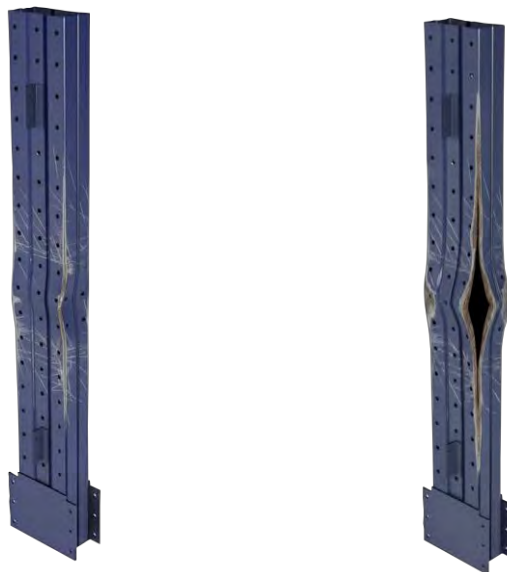
Columnas dañadas por abolladura y desgarro
