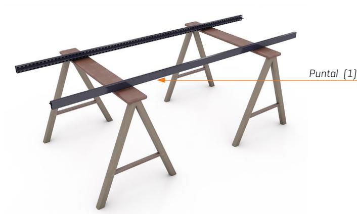
Colocar los dos puntales [1] paralelos y con sus caras perforadas enfrentadas entre sí, sobre unos apoyos o directamente en el suelo.
