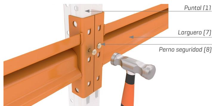
Una vez correctamente encastrados, se fijarán mediante pernos de seguridad [8]. Estos se insertan en sus alojamientos con unos pequeños golpes hasta su introducción completa.
