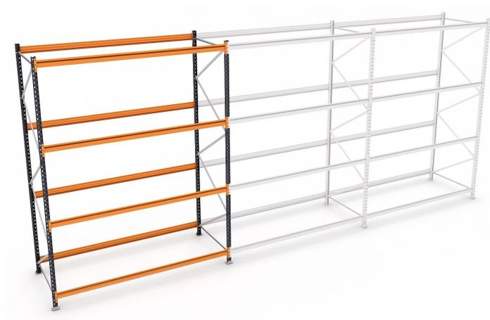
A continuación, colocar el resto de largueros [7] hasta completar todos los niveles, finalizando así el montaje del módulo inicial.
