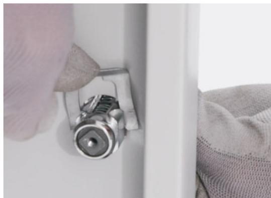
Colocamos la horquilla, por la parte interior de la puerta, para evitar que la cerradura se pueda extraer.
