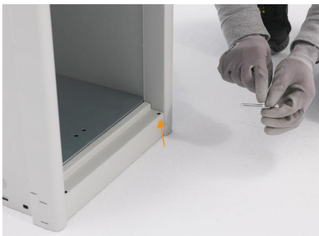
Para la colocación de la puerta se debe introducir primero el bulón inferior, y colocar la puerta sobre el mismo.
