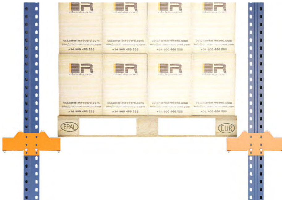
Sobrecarga por descentrado de carga
