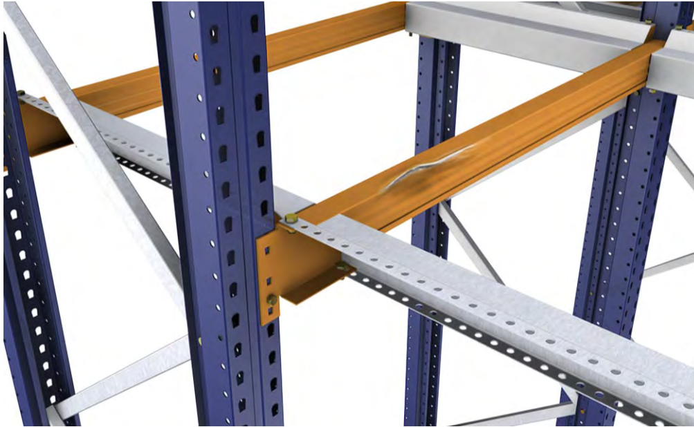
Larguero dañado por abolladura
