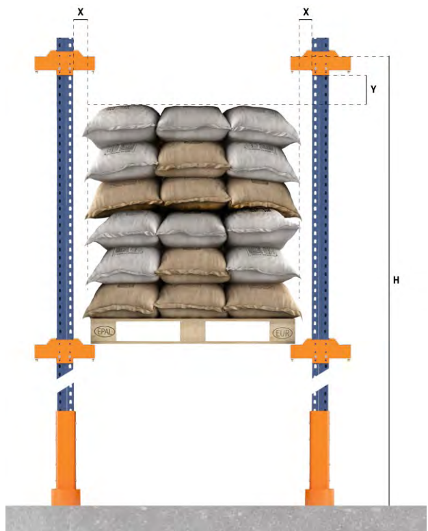
Holguras horizontales y verticales en alveolo Paletas con carga saliente situadas en niveles elevados
