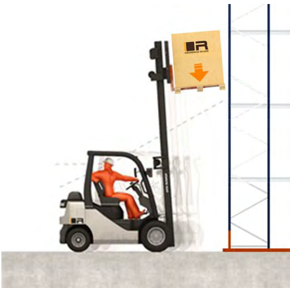
Operación de descarga
