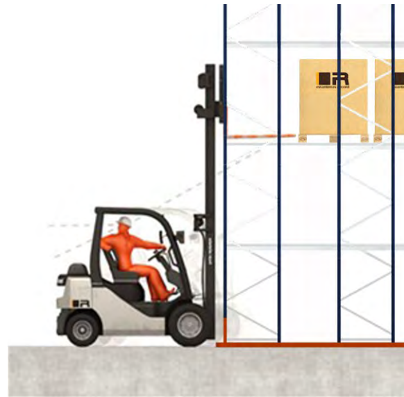
Operación de carga 4. Salida sin contacto de las horquillas con la paleta
