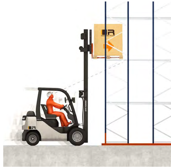
Operación de carga 2. Introducción horizontal en la posición de carga
