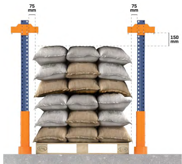
Holguras horizontales y verticales en alveolo Paletas con carga saliente situadas en el suelo
