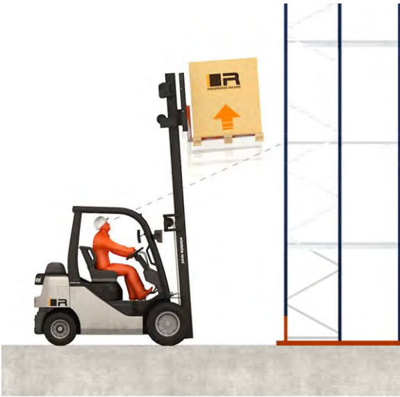
Operación de carga 1. Aproximación y posicionamiento perpendicular
