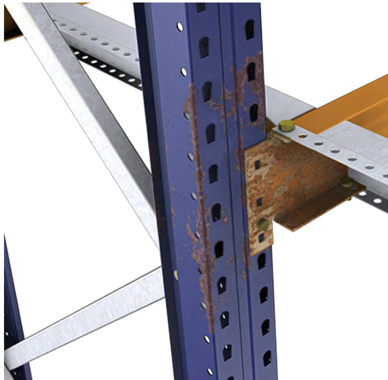
Puntero y larguero dañados por deterioro de la pintura
