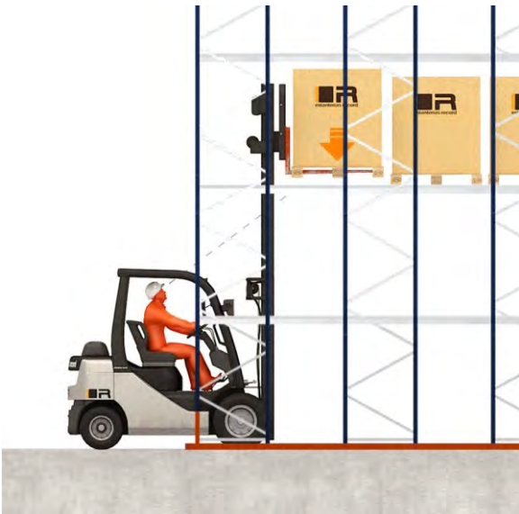
Operación de carga 3. Descanso horizontal, centrado y suave de la paleta
