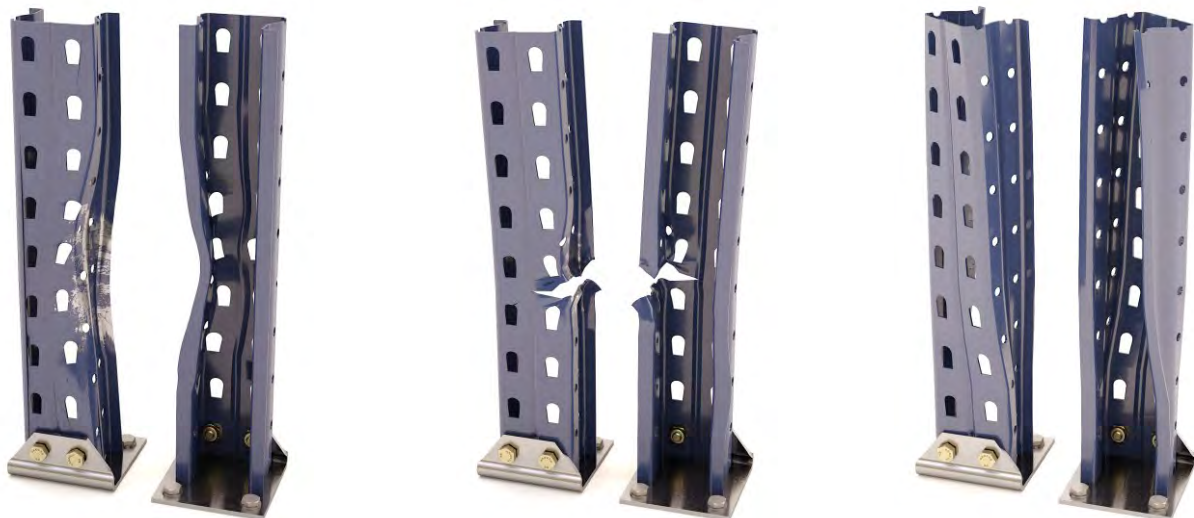
Puntales dañados por abolladura, desgarró y torsión
