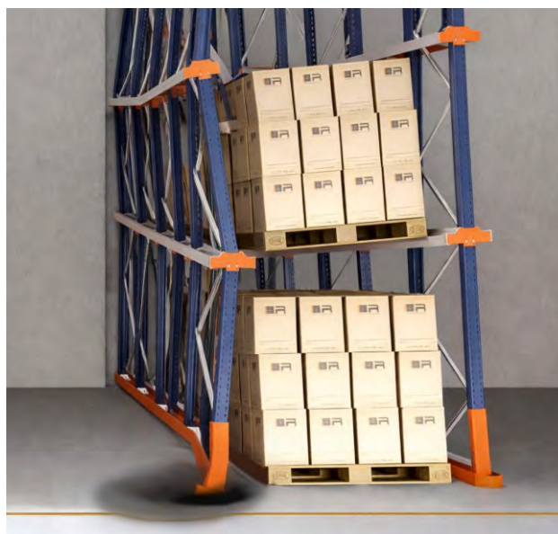
Colapso de la estructura por asentamiento del suelo bajo un bastidor
