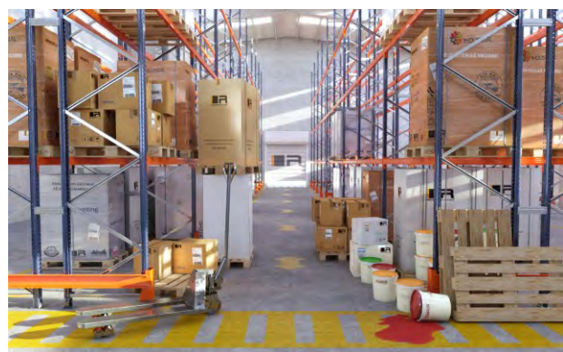
Pasillos desordenados. Condiciones inseguras de trabajo
