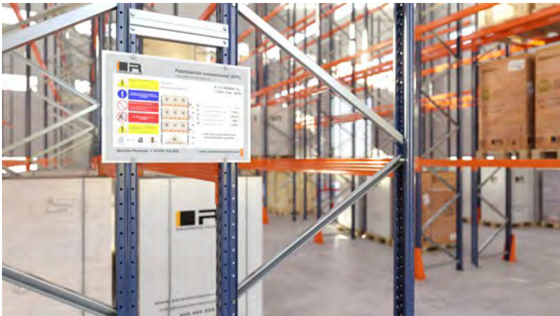
Placa normalizada de características correctamente situada
