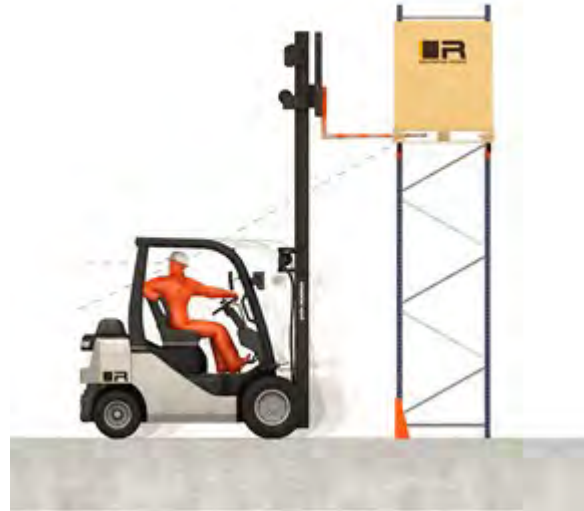
Operación de carga 4. Salida sin contacto de las horquillas con la paleta
