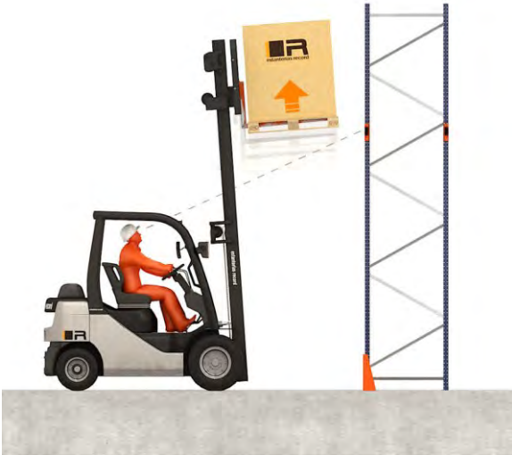
Operación de carga 1. Aproximación y posicionamiento perpendicular
