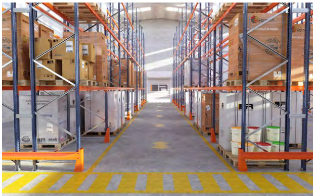
Pasillos adecuadamente libres de obstáculos
