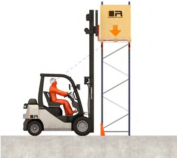
Operación de carga 3. Descanso horizontal, centrado y suave de la paleta
