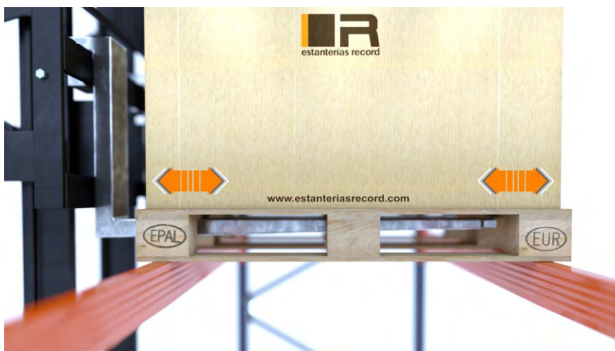
Sobrecarga sobre los largueros provocado por arrastre y empuje de la paleta
