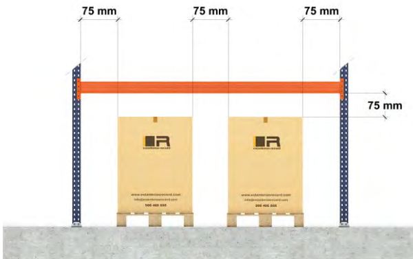
Holguras horizontales y verticales en alveolo Paletas con carga sin saliente situadas en el suelo
