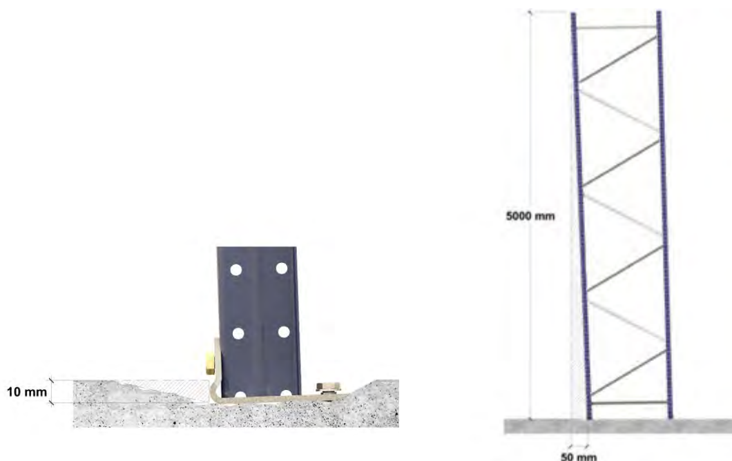
Desplomado del bastidor por asentamiento del suelo o punzonamiento local del puntal
