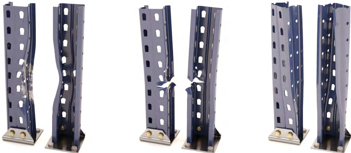
Puntales dañados por abolladura, desgarró y torsión
