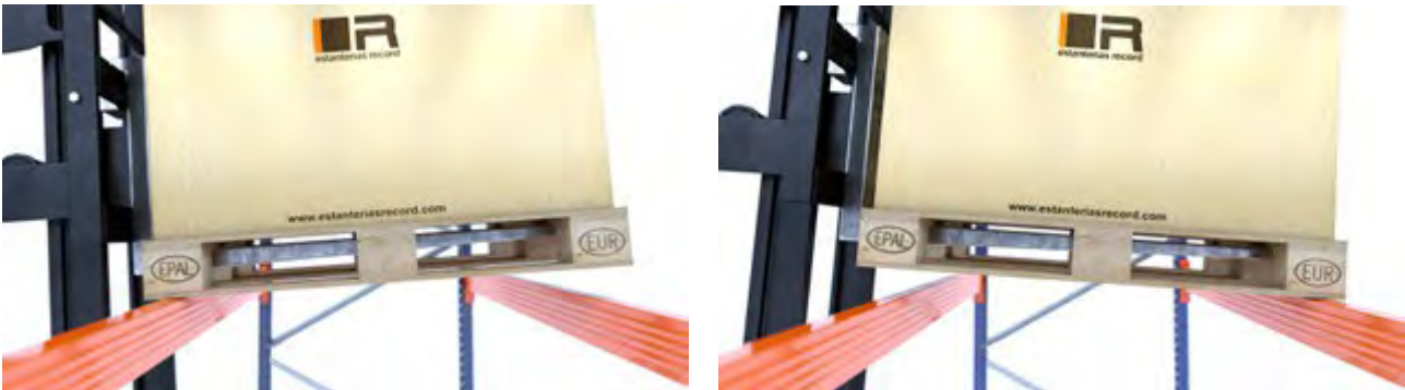
Sobrecargas en un larguero por descenso no horizontal
