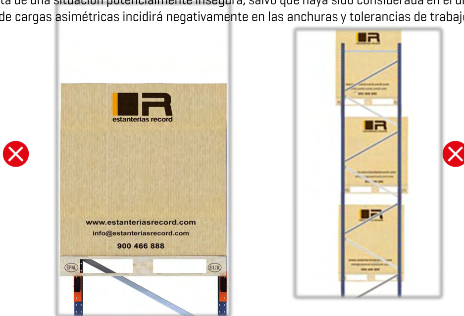
Sobrecargas por descentrado o asimetría de carga en la estantería
