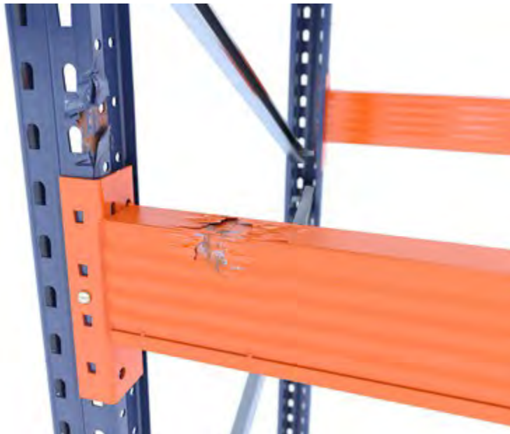
Puntal y larguero dañados por deterioro de la pintura
