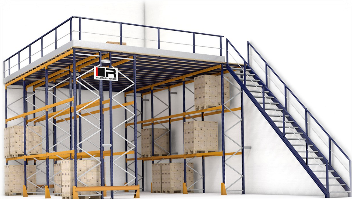
Composition de palettisation classique avec mezzanine
