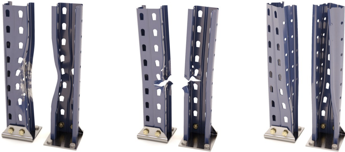
Montants cabossés, déchirés et tordus
